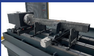
Putken porausta 4-akselilla
