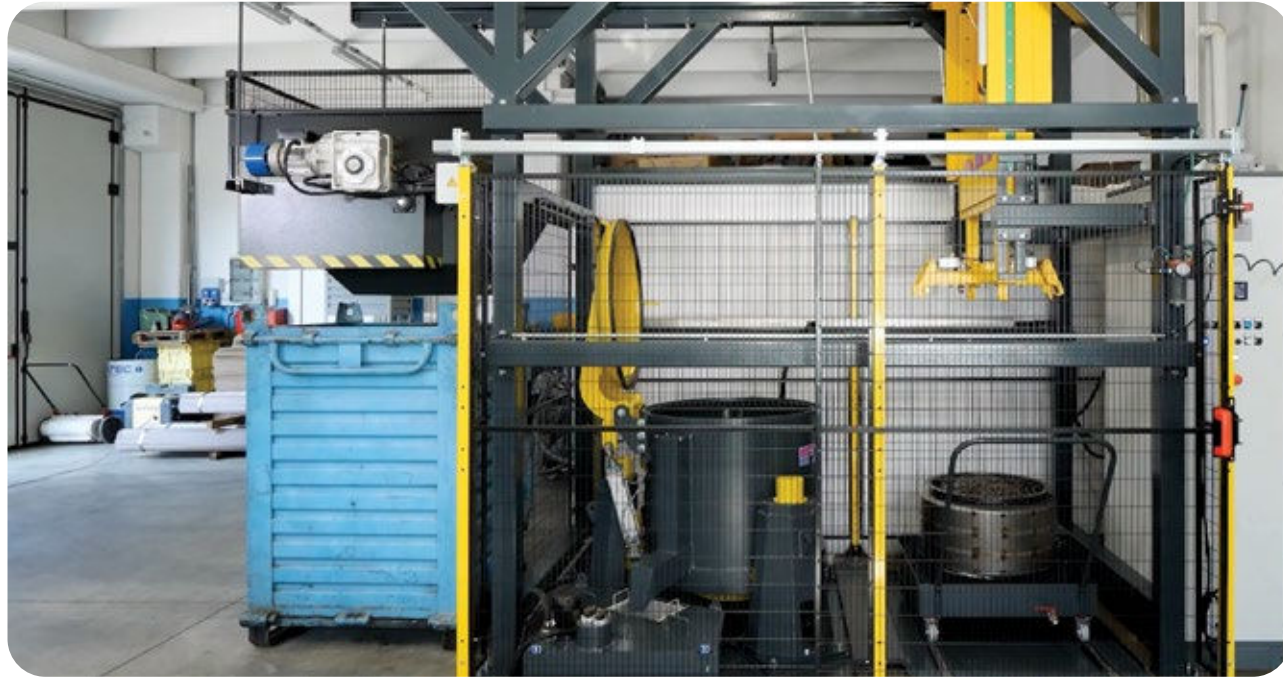
Impianto automatico di disoleatura truciolo metallico con manipolatore e centrifuga a paniere estraibile.
